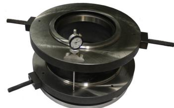
④大端环规RC和基准环规RA分别旋入接头的两端，通过检测环规端面距离计算石墨电极接头外锥螺纹的大端中径值和双侧半头同轴度。
