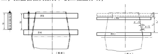
⑩使用校正柱将百分表调“0”，将基准环规RA、小端环规RB旋入接头，测出 $\triangle T2$ 值（见图四，实际的 $T2' = \triangle T2 + T2$ ），代入报告中给出的修正值，计算锥度。计算原理如图五；
