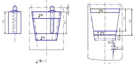
⑩测量电极内锥螺纹的锥度（如图一、图二所示）
