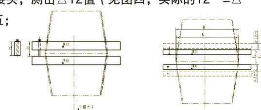
将基准环规RA、大端环规RC旋入接头两端，使用校正柱将百分表调“0”位；读出 $\triangle C2$ 值，（见图六，实际的 $C2' = \triangle C2 + C2$ ），计算实际中径值；
